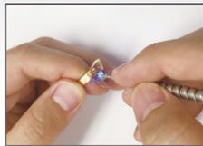
ファイバープローブの先端近くを指で持ち、ダイヤモンドとの距離を2mm未満に保ってUV光をあてます。
